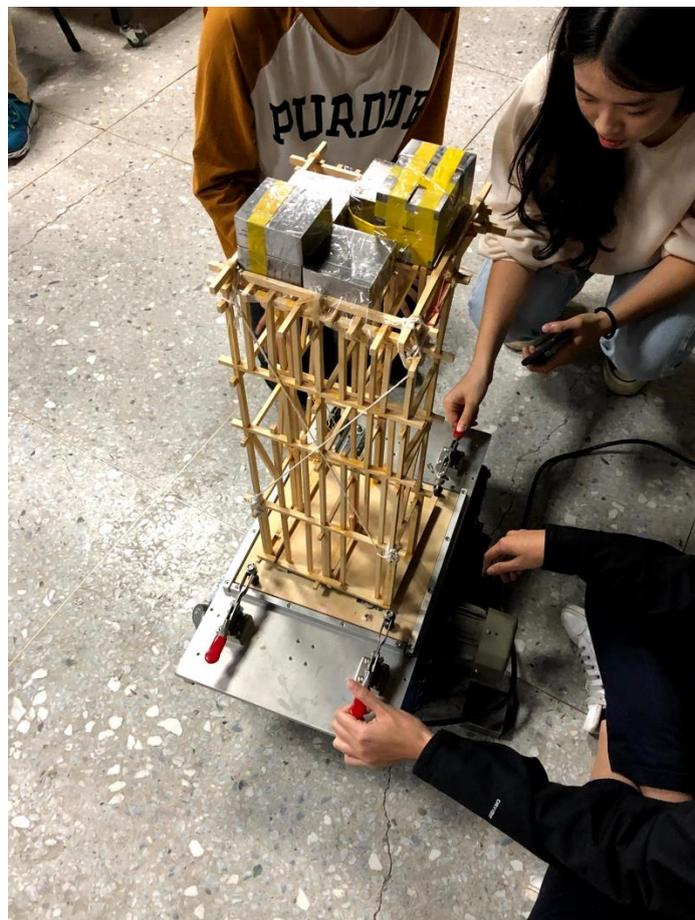
圖4 工程設計參考作品：抗震結構塔
