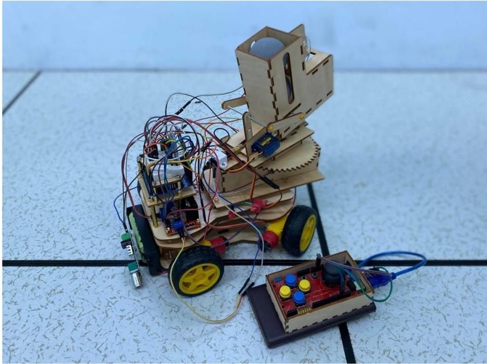
圖5 機電整合實物參考作品：遙控發球車
